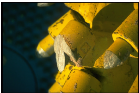
Bild 3 Typischer asymmetrischer Verschleiß (Verschleißklasse 3, Tabelle 2) der abgenutzten Außenmeißel am Querschneidkopf der Teilschnittmaschine (300 kW Altenbergtunnel). Fig. 3 Typical asymmetric wear (Wear type 3, Table 2) of the outer cutter head bits of the used roadheader (300 kW Altenberg tunnel).
